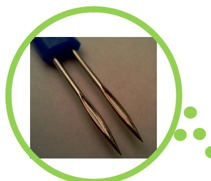
Mit dem kleinen Plastikgriff sind zwei vernickelte Stahlkanülen verbunden, welche Mikroinjektionen ermöglichen.
